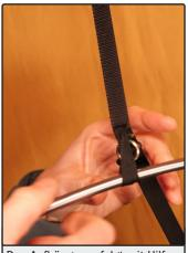
Das Aufhängen erfolgt mit Hilfe der T-Haken und O-Ringe.
