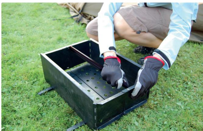
Die Aussteifung muss hochkant eingesetzt werden.
