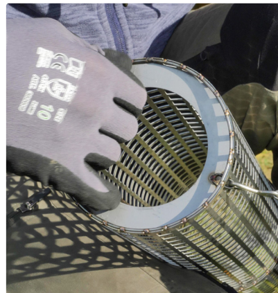
Bringen Sie die Scheibe so im Isolierrohr an, dass die Kette durch die oberste Lochreihe führt.
