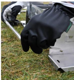
Platzieren Sie die Stützbogen in den Aussparungen auf jeder Seite des Chassis.
